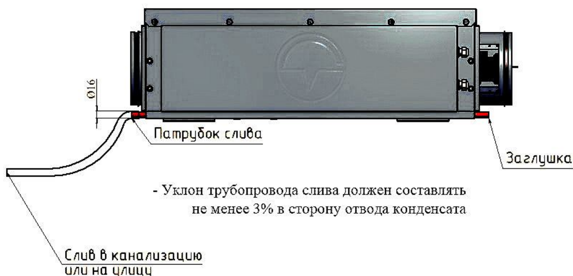
Рис.19. Вариант организации слива конденсата
